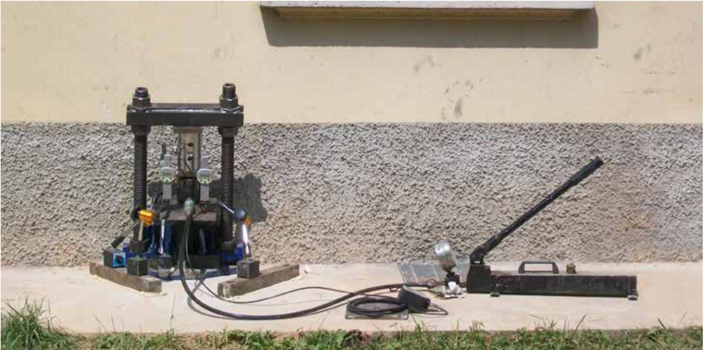
Dank dieser Proben ist es möglich, eine Kurve Belastung-Bodensenkung des getesteten Mikropfahls zu erstellen. Im Folgenden ein Beispiel.
